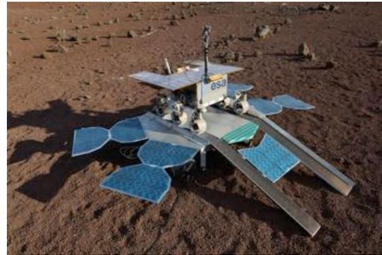
Figure 2: ExoMars 2020 egress test at CNES mars yard SEROM.
